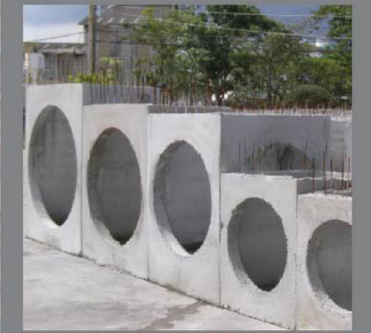
บ่อพักคอนกรีต
